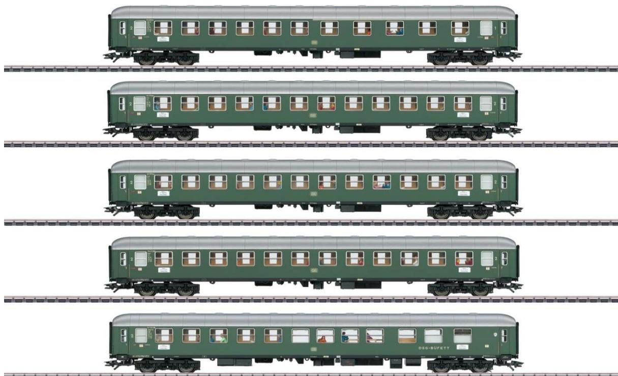
Vorbild: 5 verschiedene Schnellzugwagen unterschiedlicher Bauarten, in der Ausführung der Deutschen Bundesbahn (DB), für den Schnellzug D96 "Isar-Rhone", mit dem Zuglauf München - Kempten - Lindau - Zürich - Bern - Genf. 1 Schnellzug-Abteilwagen AB4üm-63, 1./2. Klasse. 3 Schnellzug-Abteilwagen B4üm-63, 2. Klasse. 1 Schnellzug-Halbspeisewagen BRbu4üm-61, 2. Klasse. Alle Wagen in chromoxidgrüner Grundfarbgebung. Betriebszustand um 1965.
