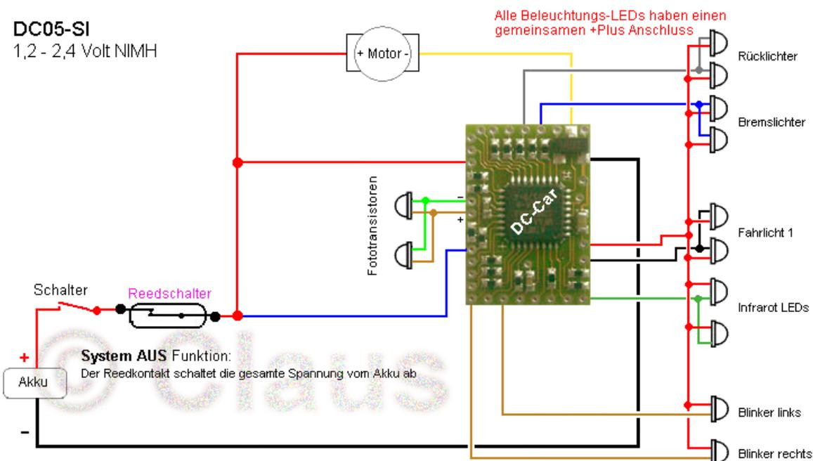
Wird der Servo-Hebel aus dem Wirkungsbereich des Reedkontakts gedreht, so wird der Decoder und damit das Auto wieder eingeschaltet.
