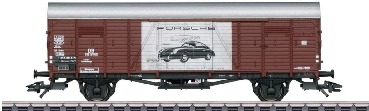
Vorbild: Zweiachsiger gedeckter Güterwagen der Austauschbauart Glt 23 "Dresden", ohne Handbremse, mit hohen doppelflügeligen Stirnwandtüren an beiden Wagenenden. Privatwagen der Firma Porsche, Stuttgart-Zuffenhausen, eingestellt bei der Deutschen Bundesbahn (DB). PKW Porsche 356. Betriebszustand um 1959.
