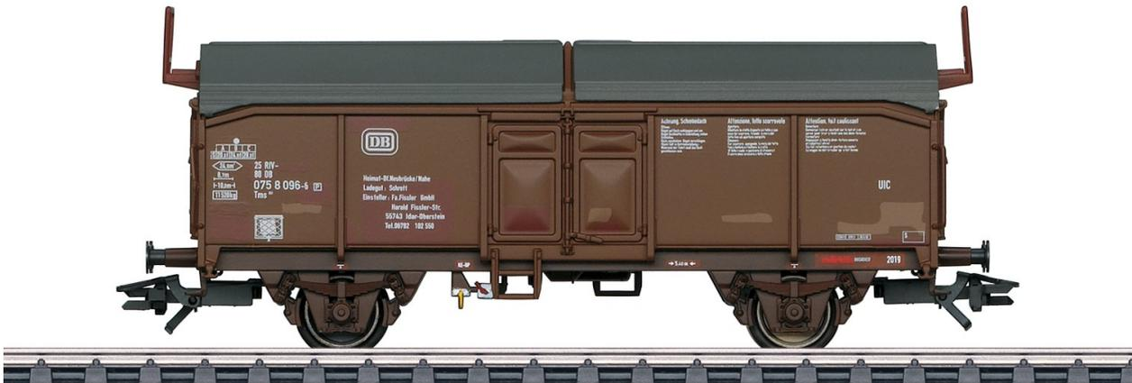
**Vorbild:** Zweiachsiger Schiebedachwagen Bauart Tms 851. Privatwagen der Firma Fissler GmbH, Idar-Oberstein, eingestellt bei der Deutschen Bundesbahn (DB). Ohne Bremserhaus und ohne Bremserbühne. Betriebszustand um 1990.
